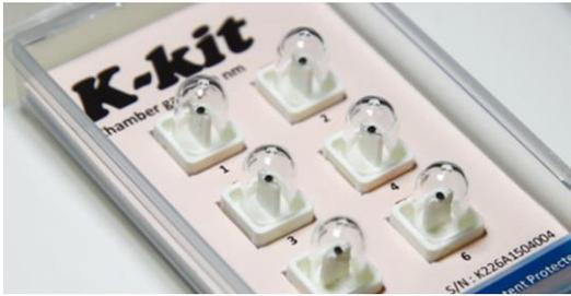
K-kit 是個微型液體樣品槽晶片。其結構採用獨家專利的單體式設計、並以 TEM 標準銅環承載，因此可適用所有廠牌的電子顯微鏡設備進行觀測。藉由 K-kit 的應用，可以在電子顯微鏡腔體內高真空環境下，直接觀測溶液中奈米顆粒的即時動態變化、尺寸外觀與群聚團聚等現象，簡單又快速地實現高品質之液態樣品影像分析。
