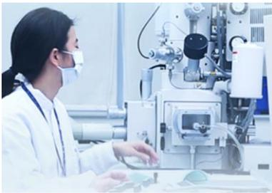
使用 SEM 觀察 K-kit 樣品，即使粒子尺寸小於 10nm 也可清楚成像 (本例載入金奈米顆粒)
