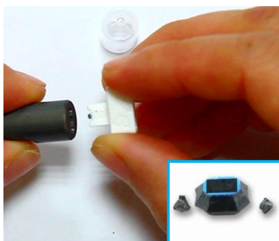
移除密封块后薄膜平坦 (通道与大气环境连通)
